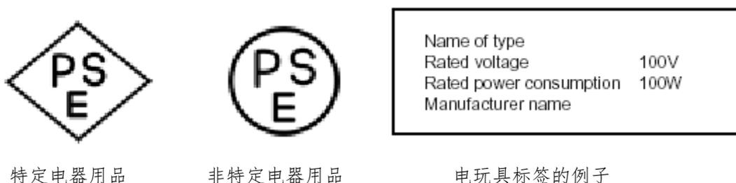
图10 日本电气用品安全法规定的标签
