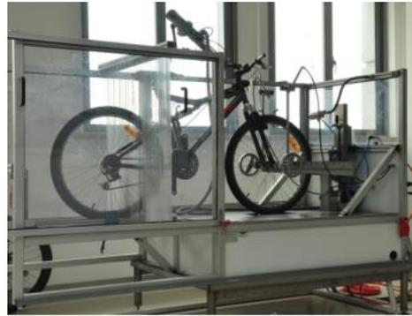
图8 制动性能试验新方法—机器法
