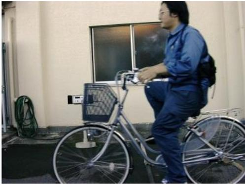
图7 传统制动性能试验方法—道路法
